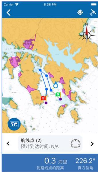
如定位成功，「eSeaGo」会引导使用者至最近的航线点。使用者当前位置与最近航线点之间，会以黄色线显示。最下方将显示到达这一个航线点的距离及真方位角，同时，系统会根据卫星提供的航速估计到达时间。
